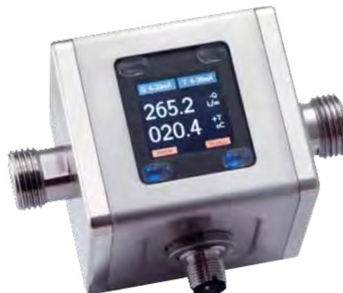
Misuratore idoneo per la misura di valori portata da un minimo di 0.04l/m (DN5) fino ad un massimo di 100l/m (DN15). Il corpo totalmente in AISI 316L rende lo strumento idoneo anche per applicazioni chimico/alimentari. Le dimensioni ridotte e la molteplicità di varietà degli attacchi filettati ne permettono una agevole e rapida installazione meccanica. La rotazione della visualizzazione del display TFT consente l'orientamento di montaggio orizzontale o verticale.
