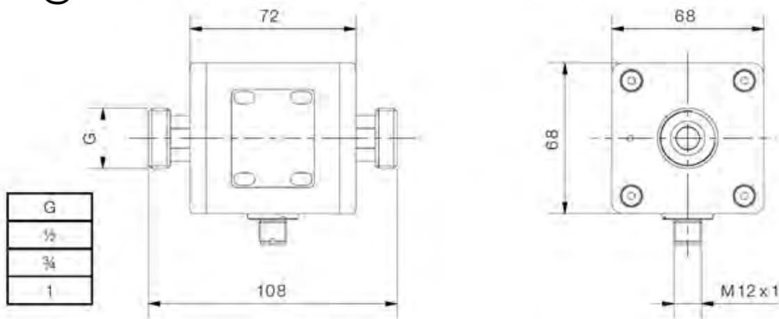
Misura di portata ad induzione elettromagnetica
