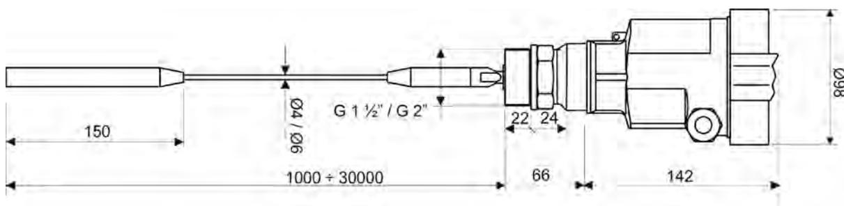
Trasm. di livello radar a microonde guidate
