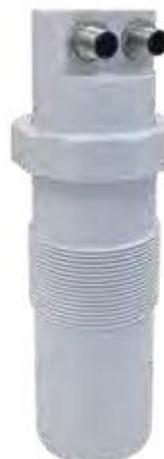
Unità compatta IP67/IP68 RADAR per misure di livelli e distanze senza contatto in applicazioni con liquidi. Con tecnologia micro-onde (elettromagnetiche) per sua natura risulta insensibile alle variazioni di temperatura, pressione ed umidità relativa, ottenendo una ottima stabilità ed accuratezza di misura.
