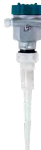
E' un sensore radar per la misura continua su liquidi, anche chimicamente aggressivi, in presenza di condizioni di processo non particolarmente gravose. Adatto alla misura di livello in serbatoi con attacchi filettati 1½"G. L' antenna a stilo sottile consente il montaggio anche in tubi di calma e la disponibilità di diverse misure dell'estensione antenna consentono l'installazione in presenza di coibentazioni o altri spessori da superare
