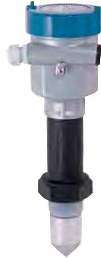
E' un sensore radar per la misura continua su liquidi, anche chimicamente aggressivi, in presenza di condizioni di processo non particolarmente gravose. Adatto alla misura di livello in serbatoi con attacchi filettati 1½"G. L'antenna di dimensioni ridotte consente il montaggio in tubi di calma o in serbatoi di piccole dimensioni, inoltre la disponibilità di diverse misure dell'estensione antenna consente l'installazione in presenza di coibentazioni o altri spessori da superare
