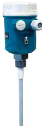
Unità capacitiva ad asta per impieghi generali o chimico-farmaceutici, adatta per la misura di livello di liquidi conduttivi, liquidi non conduttivi e granulati. Installazione nella parte superiore di serbatoi metallici.
