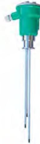
Controllo di livello conduttivo max 5 aste. Massima lunghezza elettrodi: 3m. Attacchi al processo filettati o sanitari. Isolamenti in PTFE, FEP o PVC.
