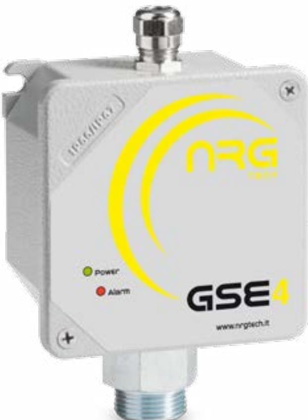
Questo sensore con un grado di protezione IP65 rileva sia gas esplosivi (metano, GPL ecc.) che tossici. Utilizza un'unità a microprocessore in grado di elaborare i dati sulla concentrazione di gas ed eseguire una calibrazione dinamica che assicura un rilevamento preciso. Grazie al suo involucro metallico, è adatto ad essere impiegato in ambienti difficili con temperature variabili evitando falsi allarmi.
