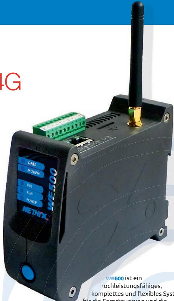
**WE500** ist ein hochleistungsfähiges, komplettes und flexibles System für die Fernsteuerung und die unbemannte Fernüberwachung über die 2G, 3G und 4G Konnektivität.
