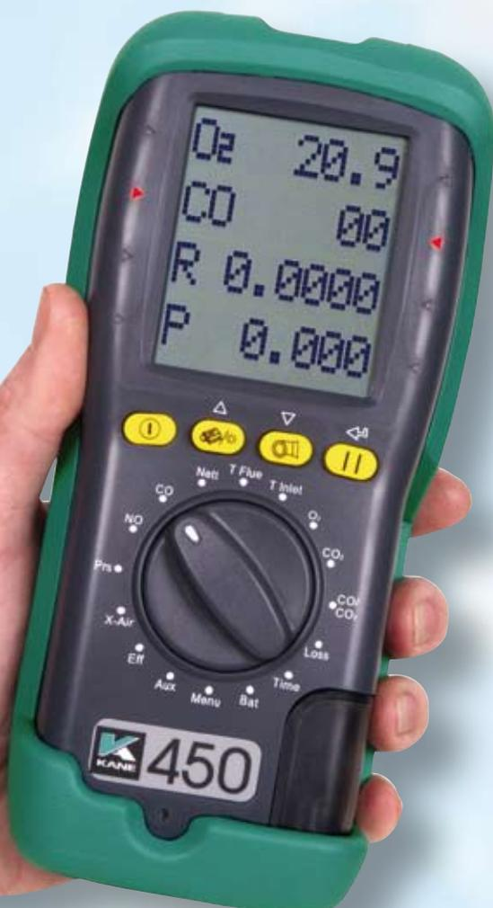
Il tester per la combustione K450 risponde pienamente a tutte le esigenze degli operatori che effettuano verifiche ed analisi di gas sulle caldaie, soprattutto a condensazione. Conforme alla legge 10/91, DPR 192 e 311, UNI 10389. Conforme alla norma sul tiraggio UNI 10845. Conforme alla norma sulla tenuta UNI 7129 e preliminare UNI 11137.
