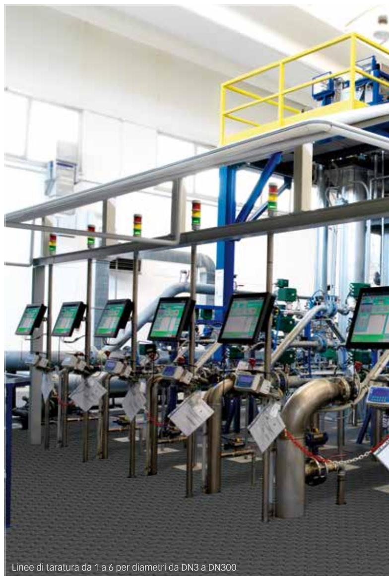
Linee di taratura da 1 a 6 per diametri da DN3 a DN300
