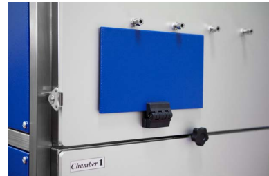
Camere di test emissione VOC: particolare degli attacchi prelievo campione sulle porte
