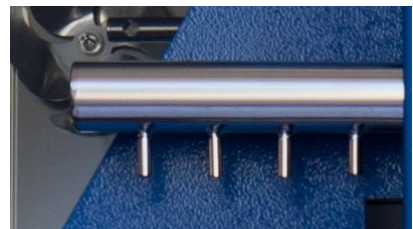
Camere di test emissione VOC: particolare del modulo di spillaggio campione
