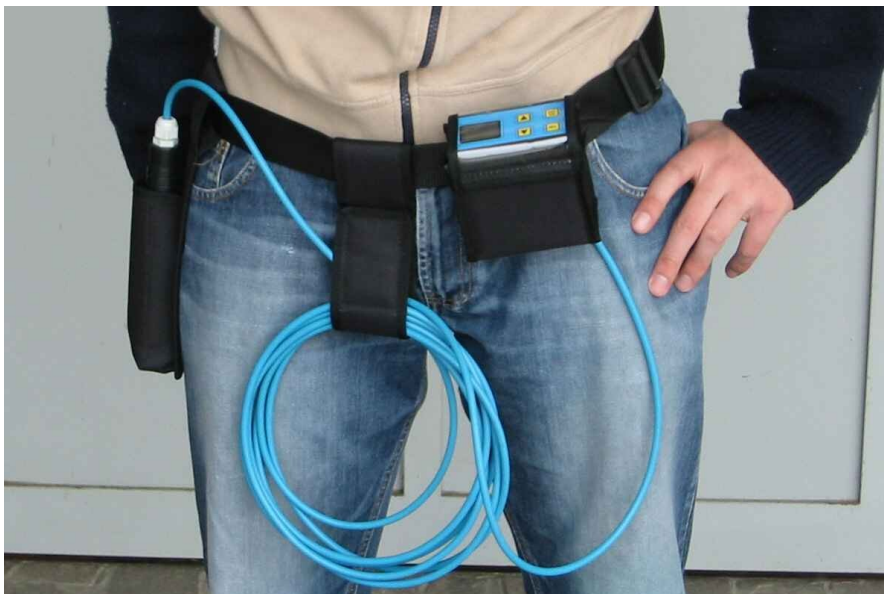
Sensore Mod.332K25D collegato a misuratore portatile di O 2 in aria serie HANDY 3000
