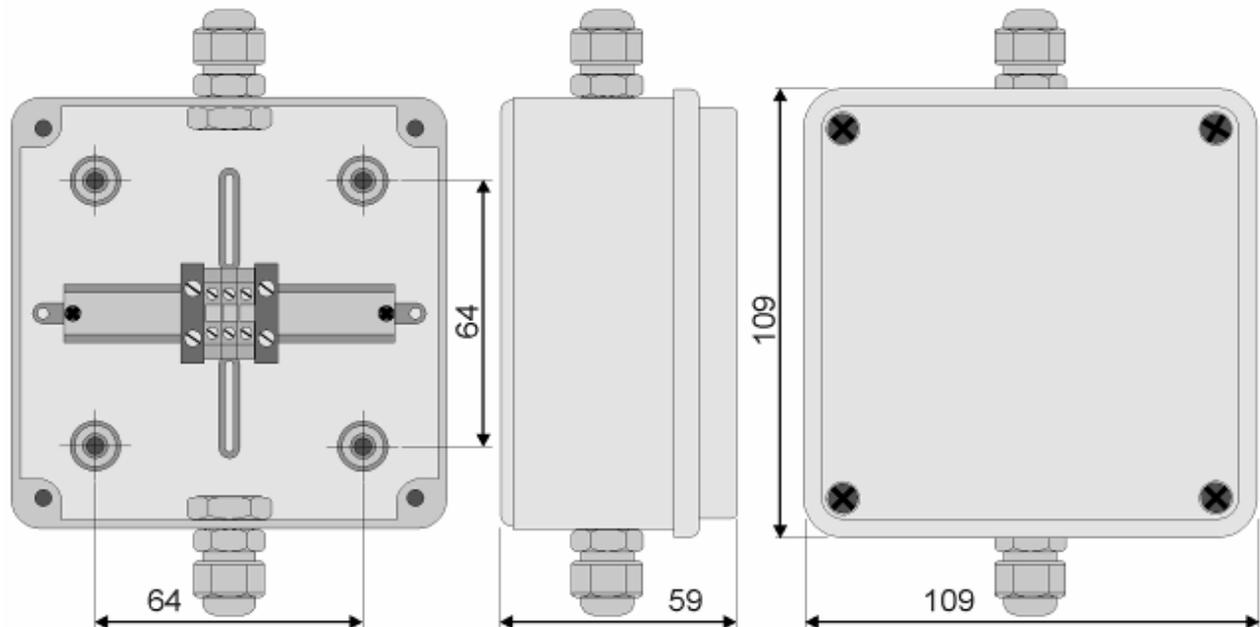
Cassetta di derivazione per collegamento del sensore allo strumento di misura remoto. La scatola di giunzione porta il numero di morsetti necessari al collegamento ed ha ingressi ed uscite cavi a tenuta. Il grado di protezione delle scatole di giunzione S/366 è IP55. E' adatta al collegamento dei sensori di misura e dei relativi sensori di temperatura.
