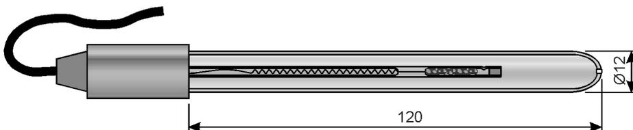
Elettrodo di riferimento industriale, Ag/AgCl, elettrolita a gel di KCl. Non richiede alcun rabbocco di elettrolita. Adatto all'installazione nelle sonde ad immersione Mod.SI0A, SI0B, SI0G, SI0H, SI0I e nelle sonde a deflusso Mod.D0A, D0C, D0D, D0E. Limiti temperatura di impiego: 0÷50 °C
