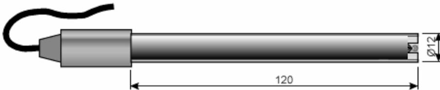
Elettrodo semplice per la misura del potenziale redox. Corpo in plastica.
