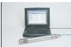
**Aquamaster:** analizzatore multiparametrico con funzionalità di datalogger e teletrasmissione dei dati.
