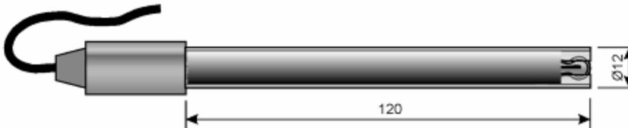
elettrodo semplice di misura del pH da laboratorio, con membrana sferica; corpo in plastica. Particolarmente robusto, è raccomandato per l'impiego con gli strumenti portatili.
