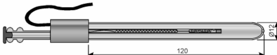
Elettrodo di riferimento industriale, Ag/AgCl, elettrolita soluzione 3.3 M di KCl satura di AgCl. Dotato di beccuccio in vetro per il riempimento di elettrolita mediante serbatoio di riserva. Adatto all'installazione nelle sonde ad immersione Mod.SI0A, SI0B, SI0G, SI0H, SI0I e nelle sonde a deflusso Mod.D0A, D0C, D0D, D0E. Limiti temperatura di impiego: 0÷100 °C
