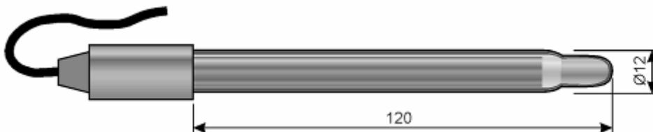
elettrodo semplice di misura del pH da laboratorio, con membrana a pera, particolarmente robusta. Da usare in combinazione con un elettrodo di riferimento. Adatto a tutti i comuni impieghi di laboratorio ed industriali.
