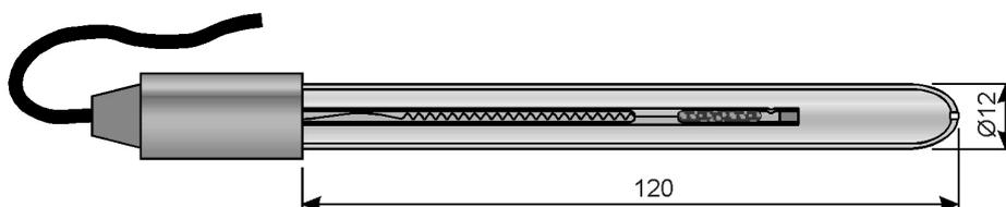
Elettrodo di riferimento industriale, Ag/AgCl, elettrolita gel solido di KCl. Non richiede alcun rabbocco di elettrolita. L'elettrolita solido permette l'impiego ad alte pressioni e temperature. Adatto all'installazione in tubazione. Limiti temperatura di impiego: 0÷110 °C
