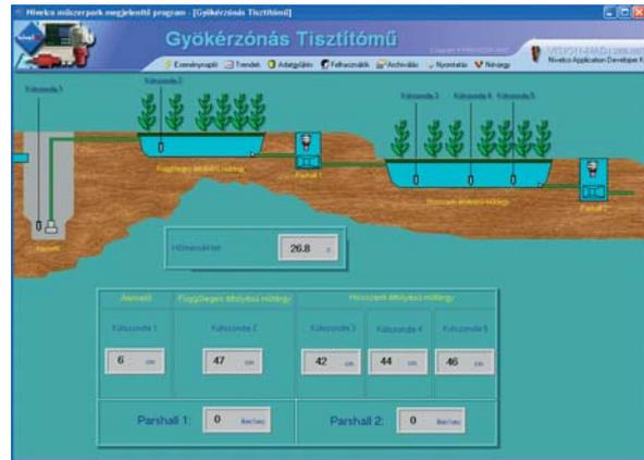
Systema di purificazione acqua: Misura di livello a spinta idrostatica con trasmettitore **NIVOPRESS**, Misura di portata in Canale **Parshall** con trasmettitore **EchoTREK**.
