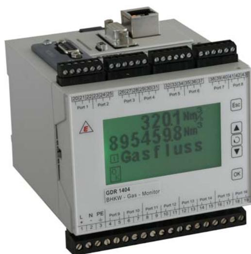
La serie GDR 1404 (misuratore flusso di gas) si contraddistingue per il calcolo diretto del fabbisogno di gas in Nm<sup>3</sup>.
