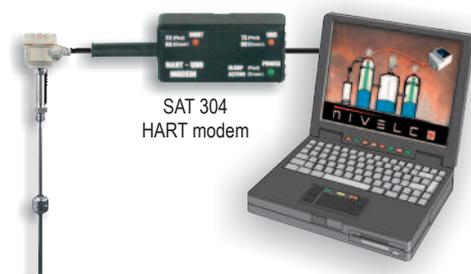
Lo strumento con uscita HART può essere collegato ad un PC utilizzando un modem-SAT-304 HART USB. Si possono collegare fino a 15 trasmettitori sulla linea HART (fino a 4 per quelli Ex). I valori misurati possono essere visualizzati e/o gli strumenti possono essere programmati tramite comunicazione digitale HART tramite i seguenti software:
